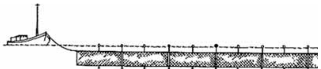
Filet maillant dérivant avec le navire auquel il est attaché
