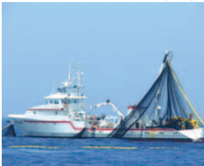
Mise en place de la poche
